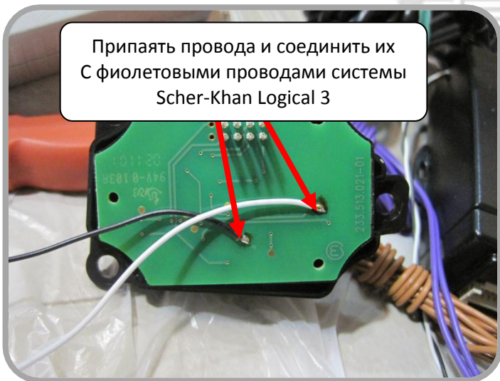
Рис. 5: Подключение цепей управления кнопкой Start/Stop.
