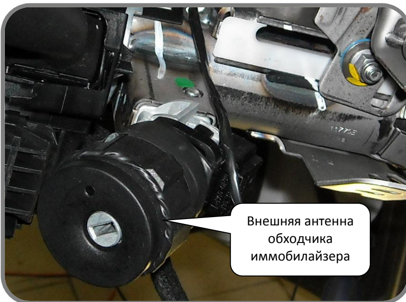
Рис. 7: Размещение внешней антенны обходчика иммобилайзера Scher-Khan BP2
