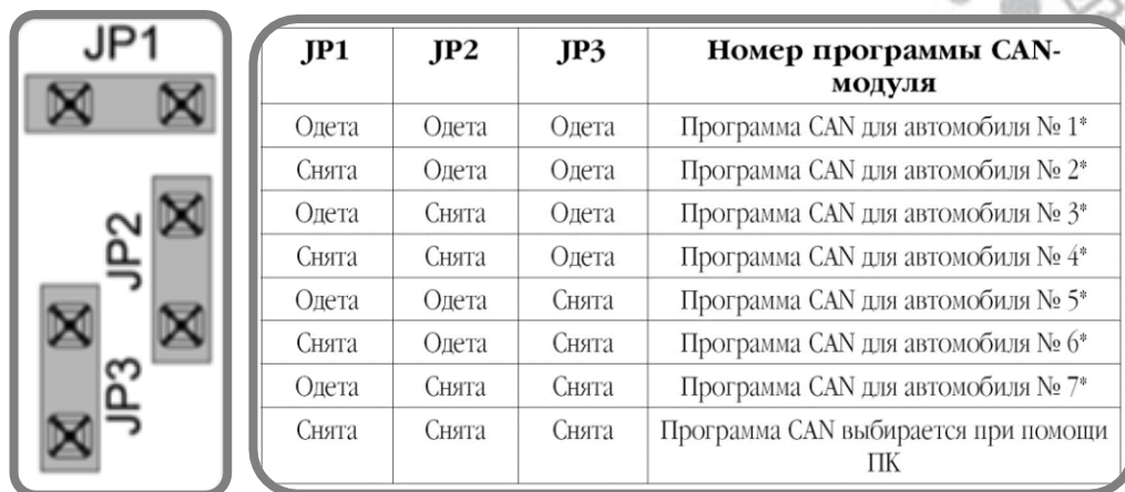
Рис. 1: Перемычки под крышкой центрального блока
