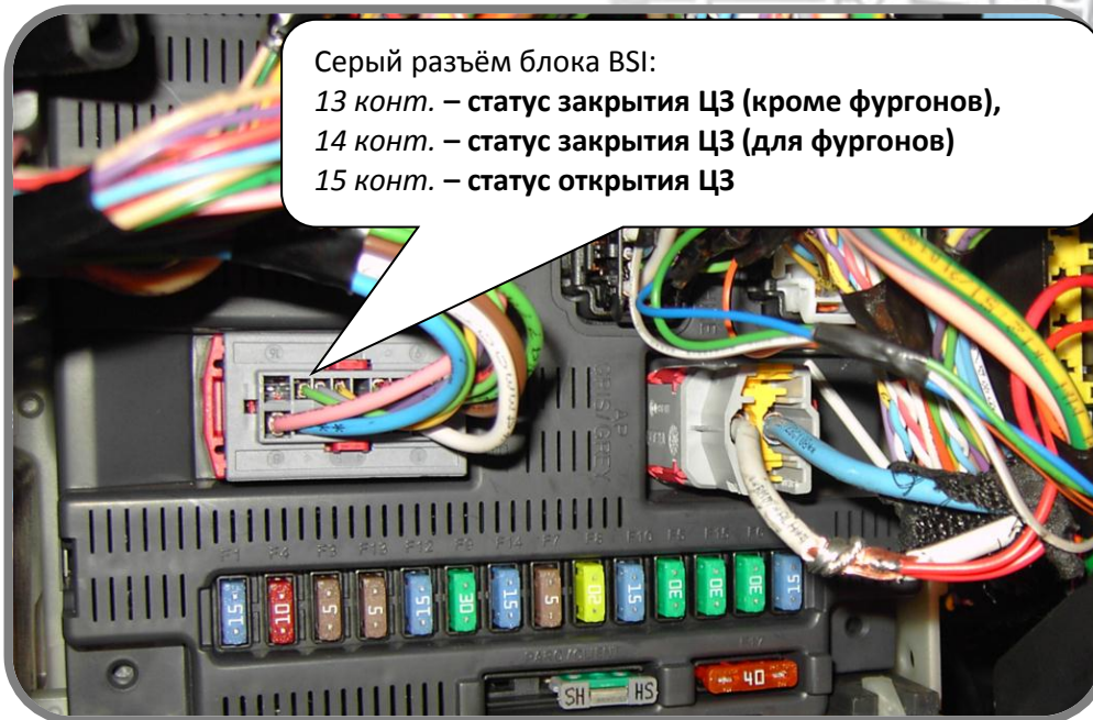
Рис. 4: Серый 16-ти контактный разъем блока BSI (статусы ЦЗ)
