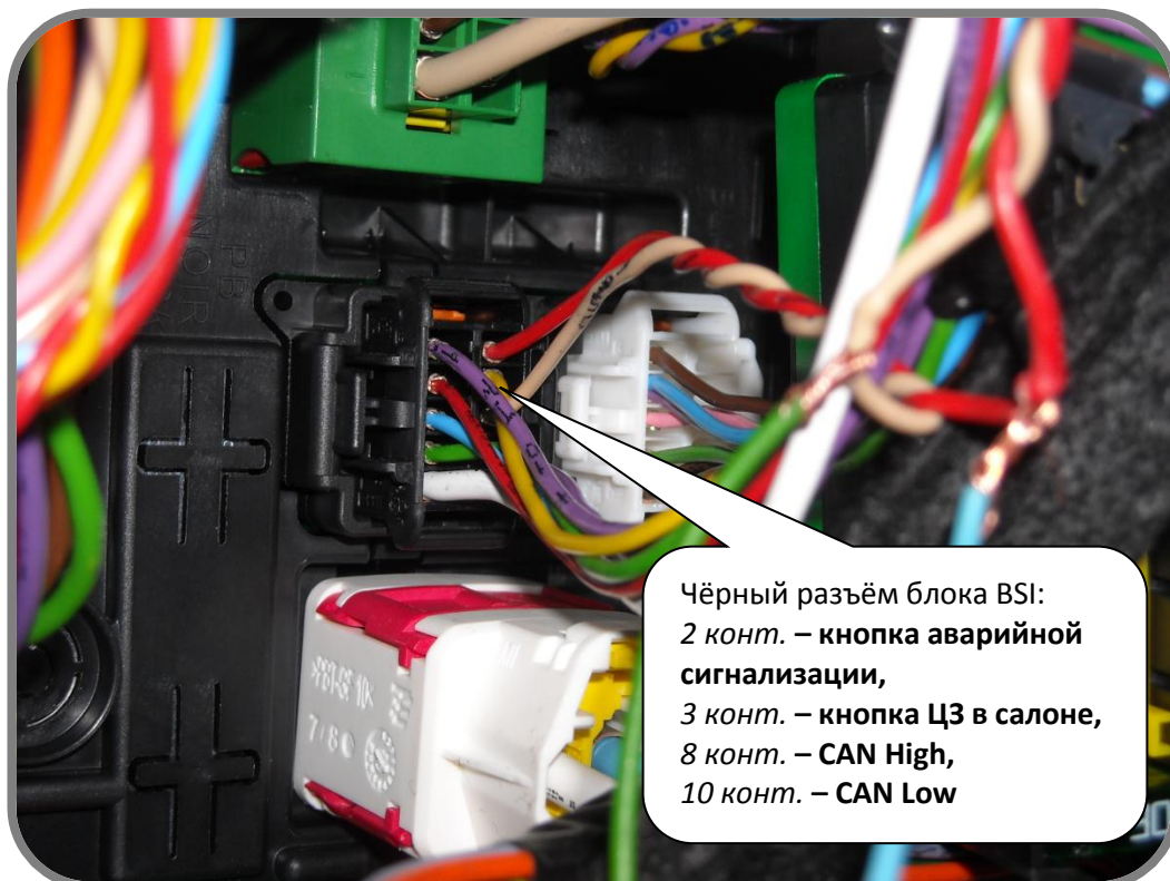
Рис. 3: Чёрный 10-ти контактный разъём блока BSI (CAN, кнопка ЦЗ, кнопка аварийной сигнализации)
