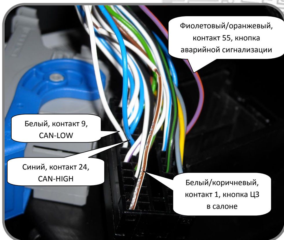
Рис. 2.2: Подключение к CAN шине, аварийной сигнализации и ЦЗ на Voxxer III (EURO 5) 2014.
