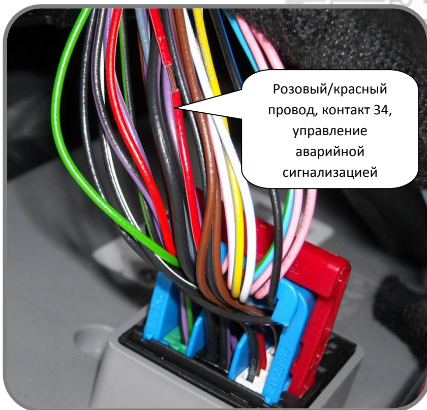
Рис. 4: Подключение аварийной сигнализации (ВСЕ ОСТАЛЬНЫЕ).
