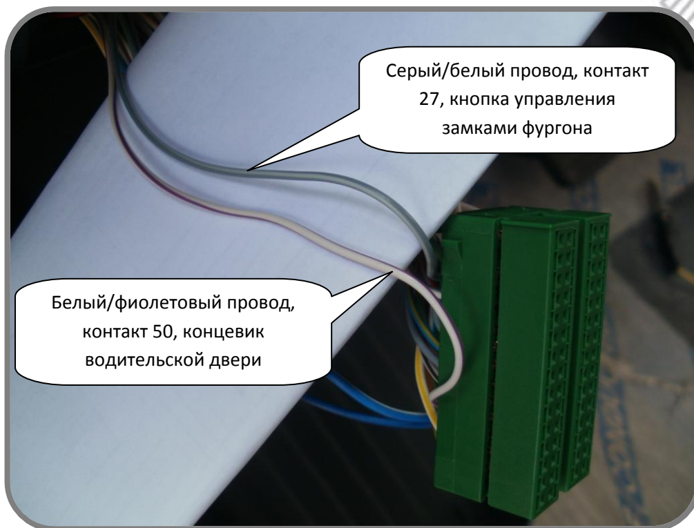
Рис. 5: Подключение ЦЗ (EURO 5).
