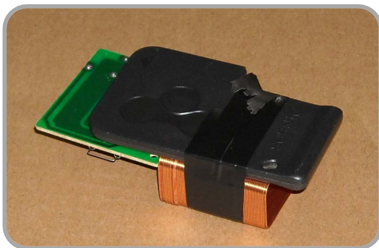
Рисунок 3 – Ключ-карта и обходчик иммобилайзера
