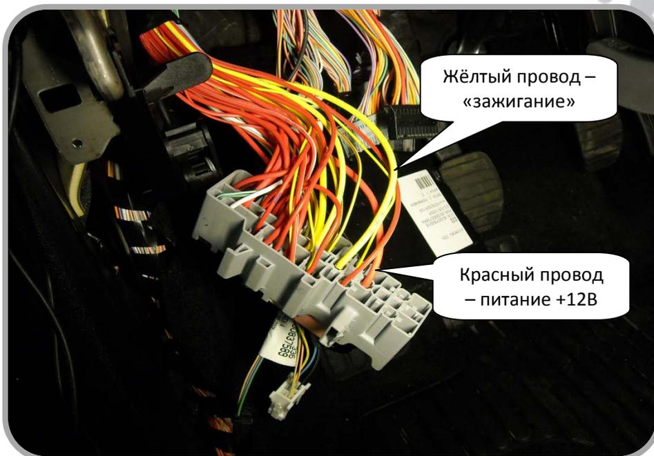
Рисунок 2 - Подключение датчика зажигания и питания +12В.
