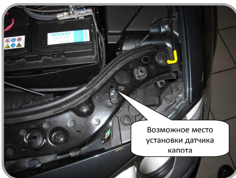
Для контроля состояния капота необходима установка датчика, идущего в комплекте с системой Scher-Khan Logicar 3. Его следует подключить к коричневому/черному проводу разъема CN4 системы Scher-Khan Logicar 3. Возможное место установки концевика капота показано на рисунке 4.
