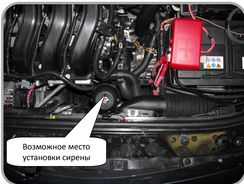
Для подключения сирены коричневый провод разъема CN2 системы Scher-Khan Logicar 3 соединить с красным проводом сирены. Черный провод сирены качественно соединить с «массой» автомобиля. Сирену располагать рупором вниз или в сторону. Возможное место установки сирены указано на рисунке 5.
