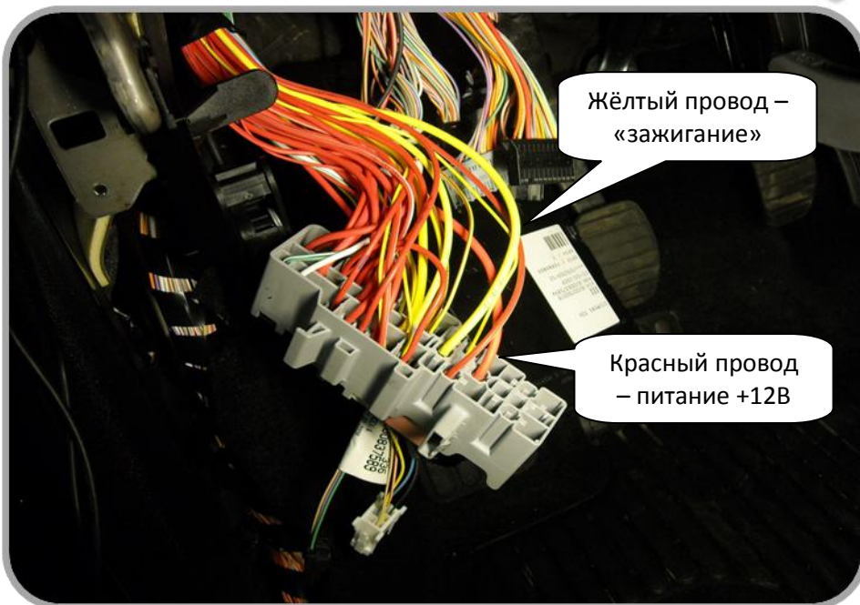
Рисунок 2 - Подключение датчика зажигания и питания +12В.
