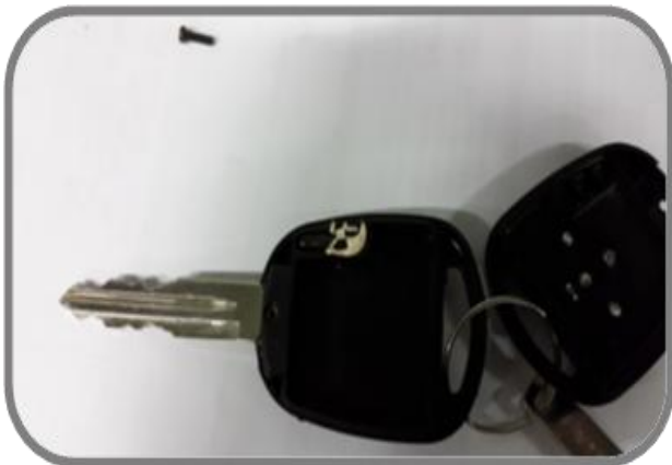
Рис. 10 Расположение чипа в штатном ключе
