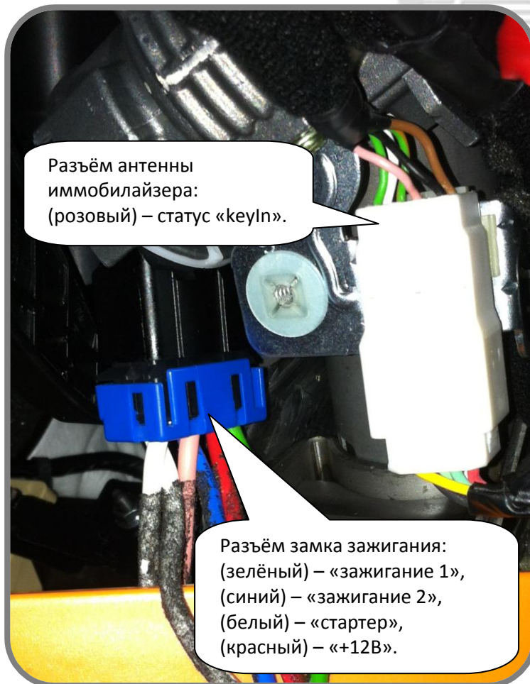
Рис. 9: Разъём замка зажигания (Для а/м без SmartKey: «зажигание 1», «зажигание 2», «стартер», статус «key in» (для а/м без SmartKey))
