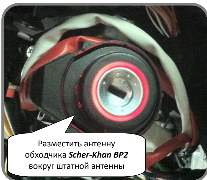
Рис. 13: Размещение внешней антенны обходчика иммобилайзера Scher-Khan BP2 (для а/м без SmartKey)
