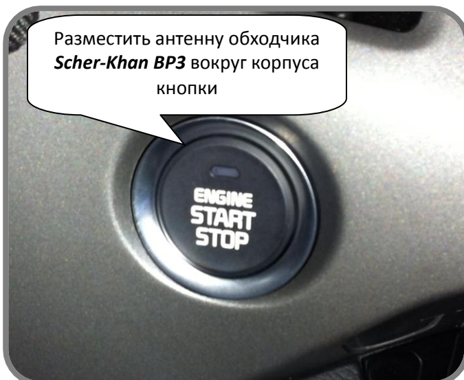
Рис. 12: Размещение внешней антенны обходчика иммобилайзера Scher-Khan BP3 (для а/м с SmartKey)
