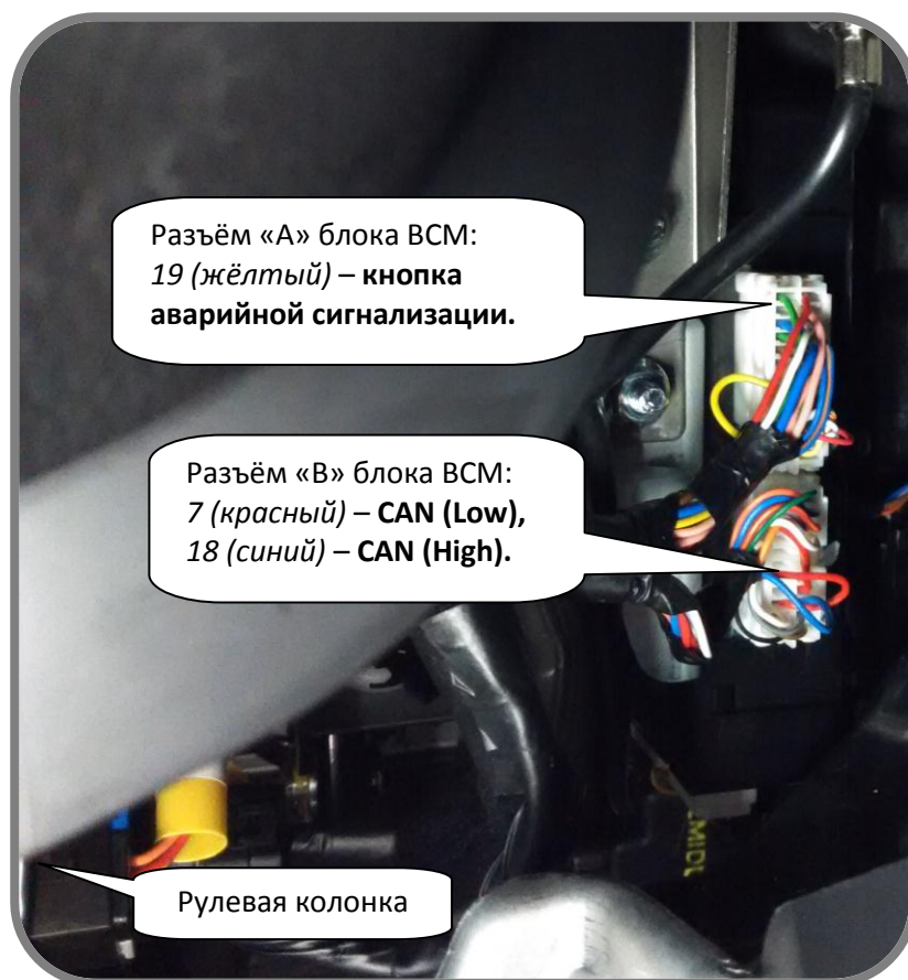
Рис. 2: Блок VCM – справа от рулевой колонки (Для всех а/м: CAN B, аварийная сигнализация)
