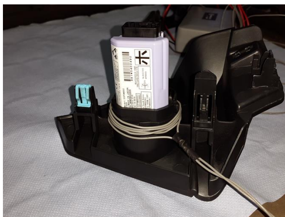
Рис. 23. Витки внешней антенны модуля обхода иммобилайзера Carmega BIS-140.
