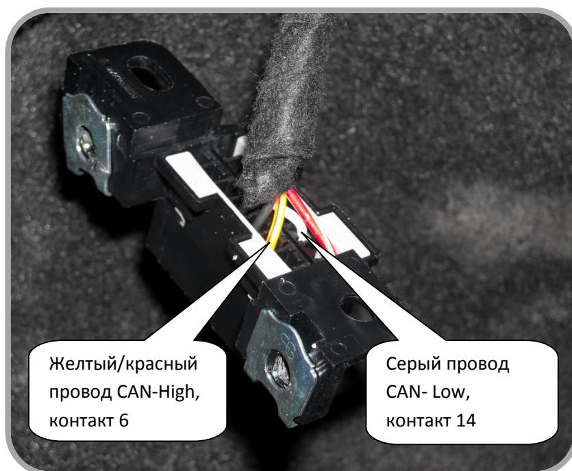
Рис. 2: Подключение к CAN шине на диагностике.
