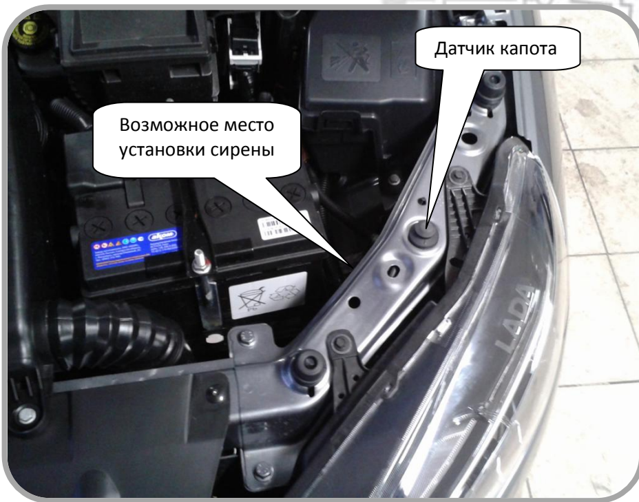
Рис.12: Возможное место установки сирены.
