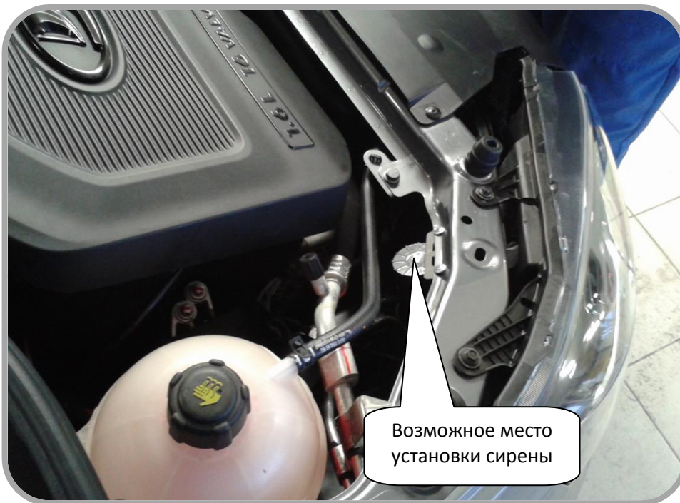
Рис.13: Возможное место установки сирены.
