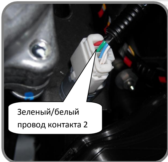
Рис.9: Имитация педали тормоза на датчике тормоза.
