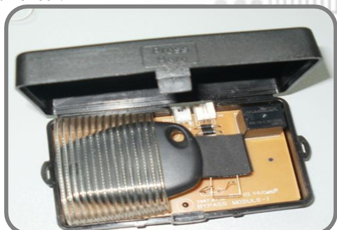
Рис.7: Размещение ключа в блоке обходчика иммобилайзера.
