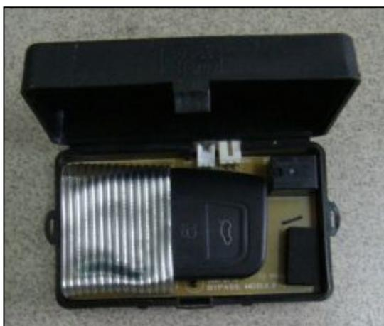
Красный провод разъема CN1 питания обходчика подключается к красному проводу разъема CN2 системы Scher-Khan Logicar 3. Черный провод разъема CN1 обходчика подключается к белому проводу «доп.канал 1» разъема CN4 системы Scher-Khan Logicar 3. Для корректной работы «доп.канала 1» установите функцию 3-6 в значение 2,
