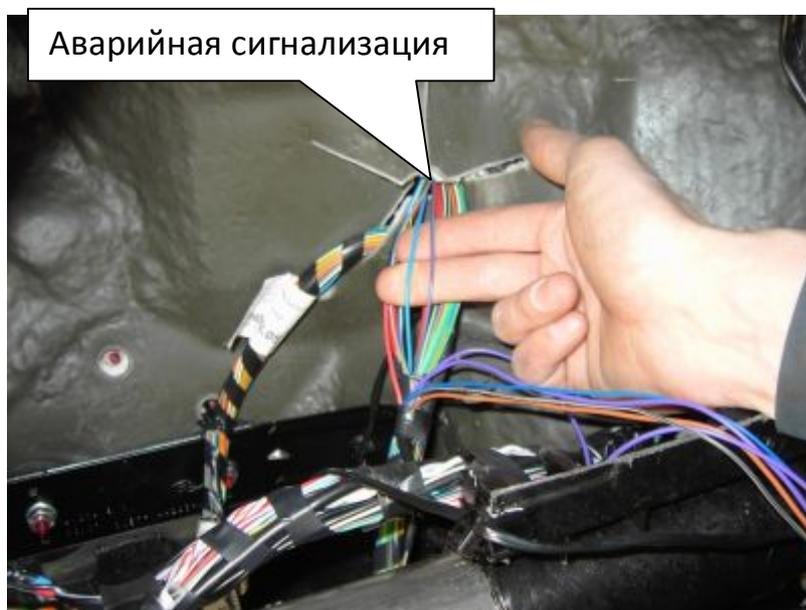
подключить к синему и синему/красному проводам, расположенным в жгуте зеленого разъема монтажного блока. Красный/белый провод разъема CN2 системы Scher-Khan Logicar 3 подключить к «плюсу» от АКБ (возможно подключение к красному проводу разъема CN2 системы Scher-Khan Logicar 3 до 5 А предохранителя).
