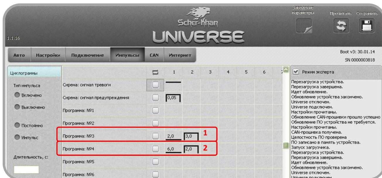
Рис. 19: Конфигуратор Universe. Страница «Импульсы».
