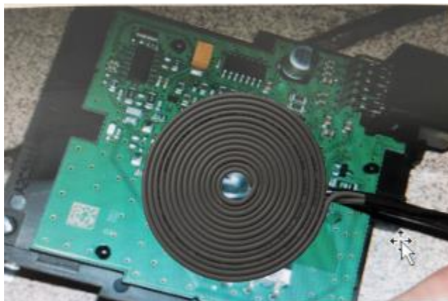
Рис. 35. Расположение внешней спиралевидной антенны модуля обхода иммобилайзера на плате считывателя.
