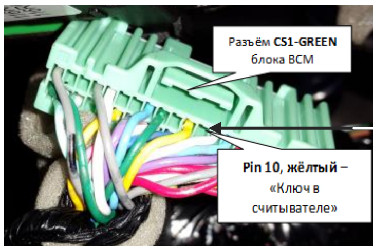
Рис. 37. Статус «Ключ в считывателе» на разъёме BCM.
