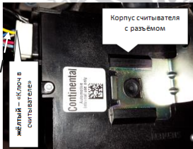
Рис. 38. Статус «Ключ в считывателе» на разъёме считывателя.
