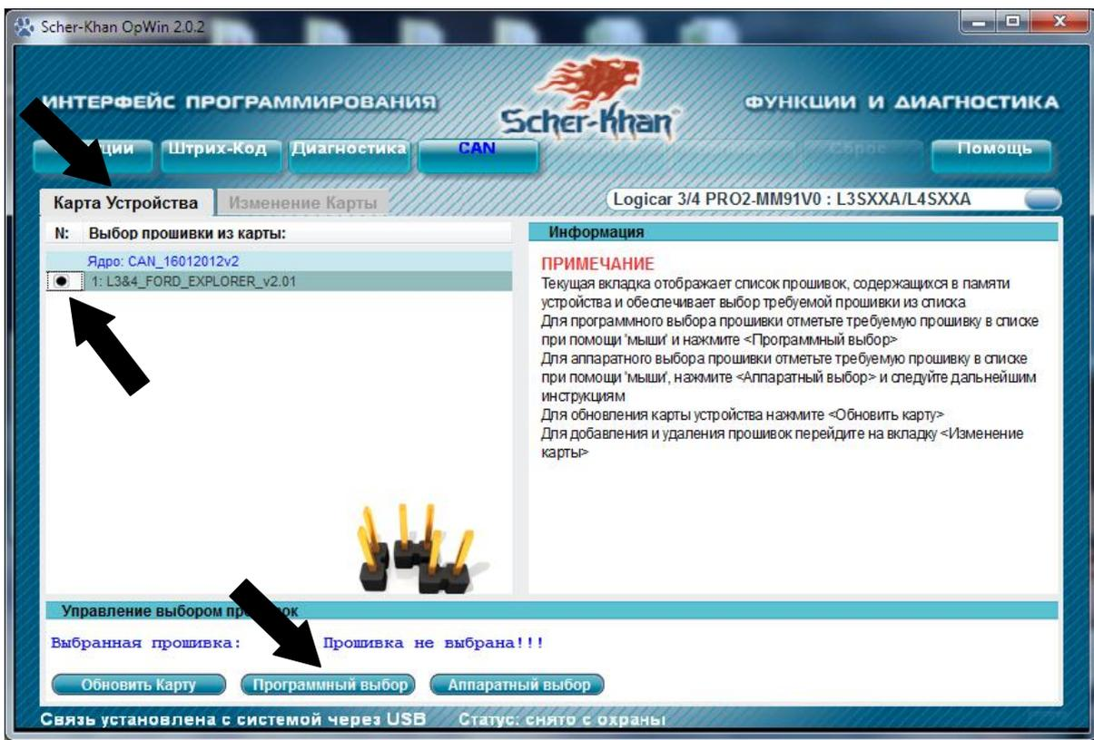
*\*Альтернативным способом выбора прошивки является «Аппаратный выбор», то есть с помощью перемычек на модуле CAN. Установите метку возле выбранной прошивки и нажмите кнопку «Аппаратный выбор», программа подскажет конфигурацию установки перемычек в блоке сигнализации.*
